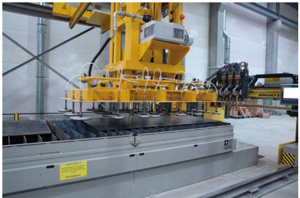
Be- und Entladung der Schneidanlage erfolgt über ein integriertes Handlingsystem
